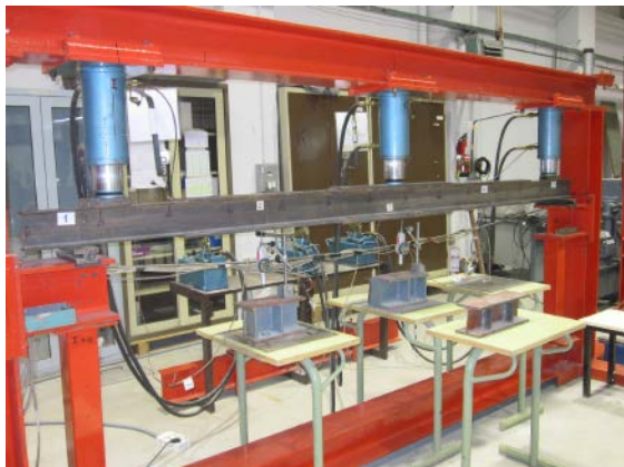
Pórtico de carga para vigas
